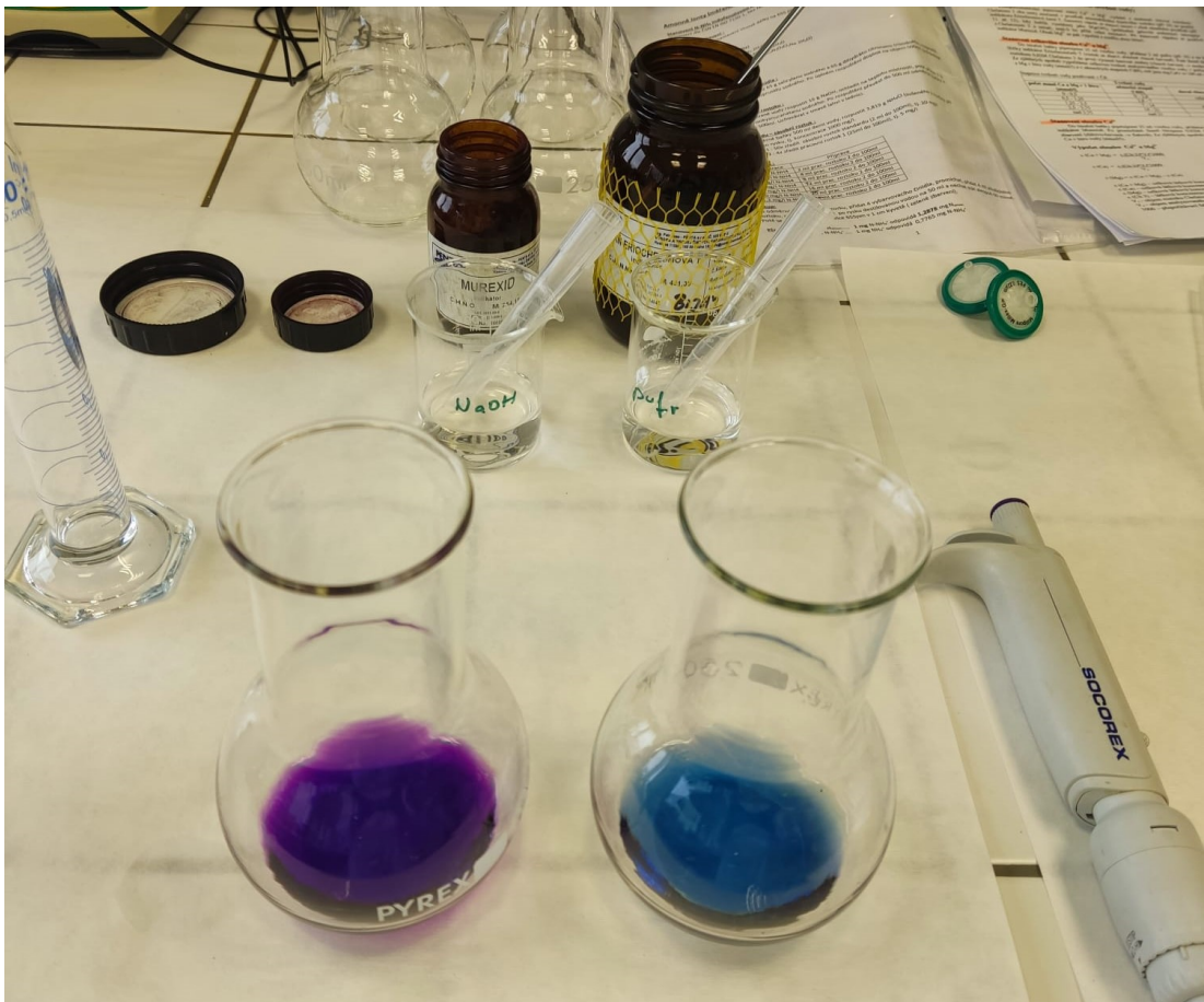
Obrázek 8 Stav po použití Chelatonu III, vlevo měření \text{Ca}^{2+} , vpravo \text{Ca}^{2+} a \text{Mg}^{2+} (zdroj vlastní, leden 2023)
