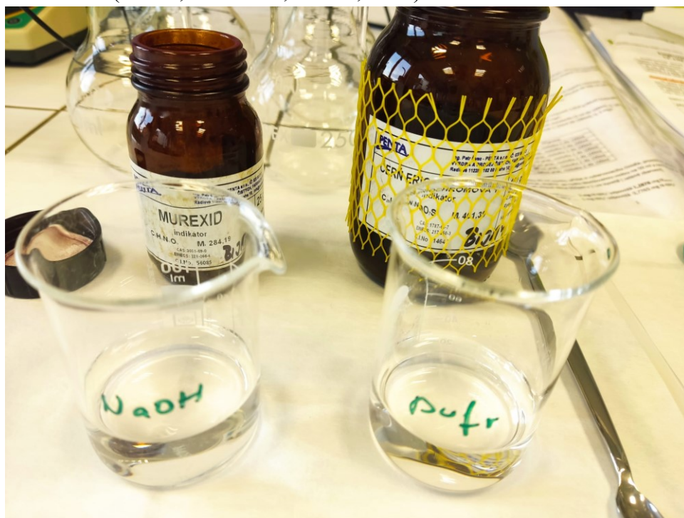
Obrázek 3 Laboratorní měření, příprava NaOH + Murexid a Pufr + Eriochromčerň (zdroj vlastní, leden 2023)
